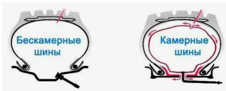
Рисунок 1 метод герметизации автомобильных шин.
