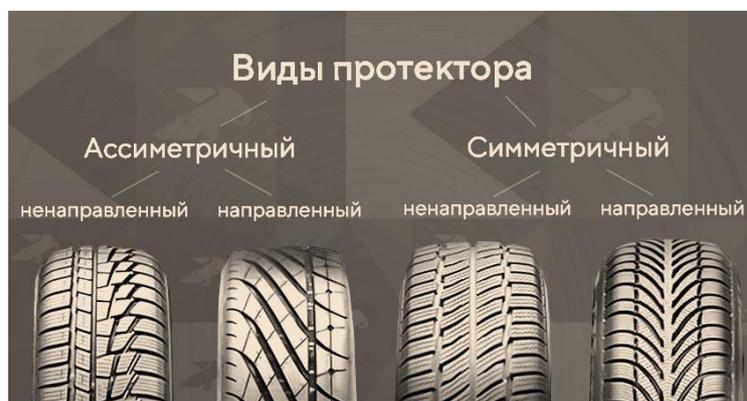
Рисунок 1 Типы рисунка протектора
