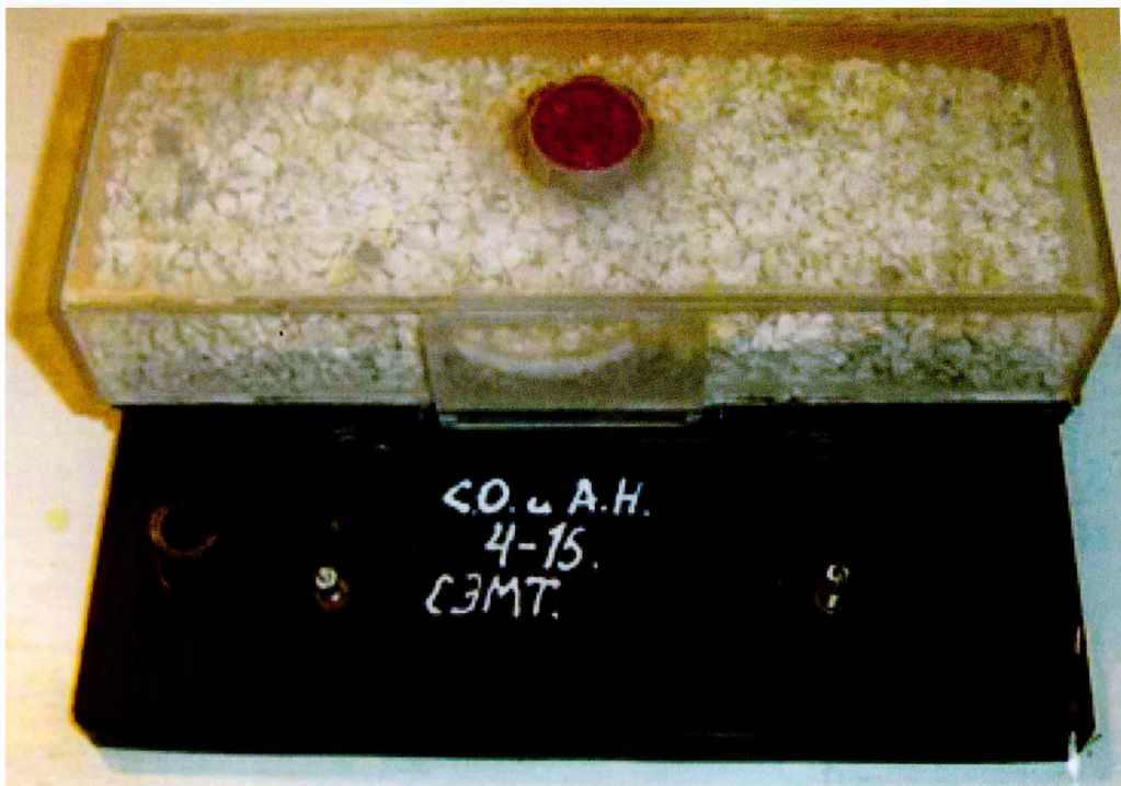
Устройство для улавливания паров серной кислоты при испытаниях на разряд
