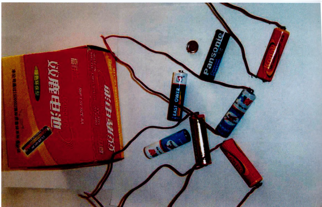
Испытания батареек на электролита-невытекаемость – один из главных критериев их качества
