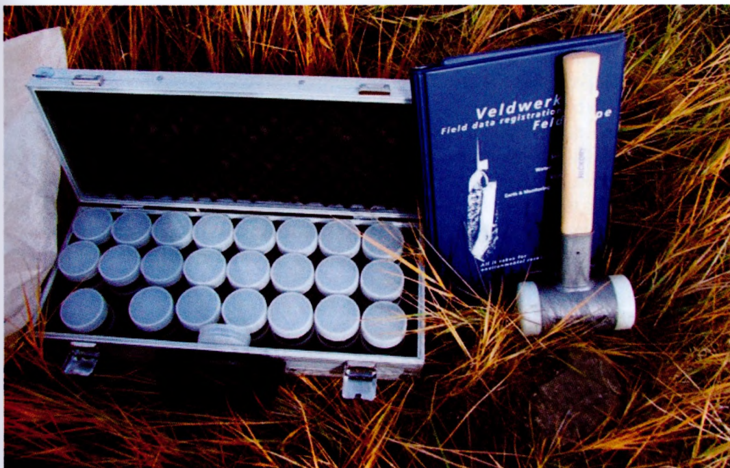
Совместный отбор проб преподавателем НИРС СЭМТ Бутаковым В. И. и профессором Богдановым А. Н. (г. Иркутск) почвогрунтов в районе бывшего завода АМЗ, загрязненных свинцом и мышьяком, для проведения анализов в лаборатории Иркутского технического университета
